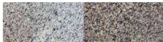
直接水冲 Water blast
